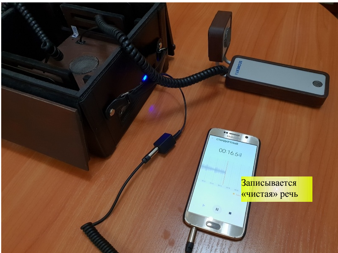
Рис.8 SEGMENT-I устроен так, что запись «чистой» речи, циркулирующей внутри трубок, можно выполнить только с разрешения всех участников переговоров. Скрытно это сделать невозможно!
